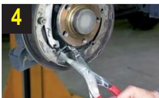
4 Da bi se izbeglo oštećenje komponenti, uvek koristite odgovarajuću posebnu alatku za ugradnju / uklanjanje **kabla ručne kočnice**
