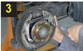
3 Da bi se izbeglo oštećenje komponenti, uvek koristite odgovarajuću posebnu alatku za ugradnju / uklanjanje **povratne opruge**
