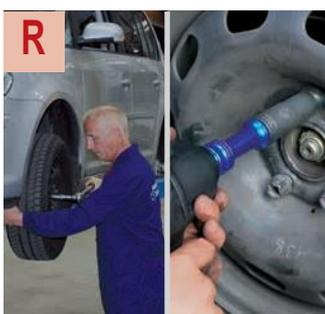
Da bi se izbeglo oštećenje glavčine točka i/ili lateralno istrošenje kočionih diskova, vijak / navrtka točka moraju da budu zategnuti u skladu sa specifikacijama proizvođača (redosled + moment zatezanja).
