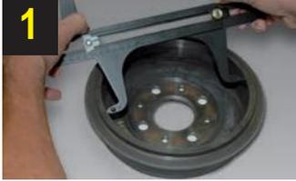
1 Pregledajte doboš kočnice na prisustvo habanja i oštećenja. Izmerite prečnik. Nova dimenzija, plus prečnik od maks. 0,5mm može da se koristi samo sa oblogama za doboš kočnice prekomerne veličine. Ležajevi točka i/ili prstenovi senzora takođe treba da budu zamenjeni, u zavisnosti od verzije.
